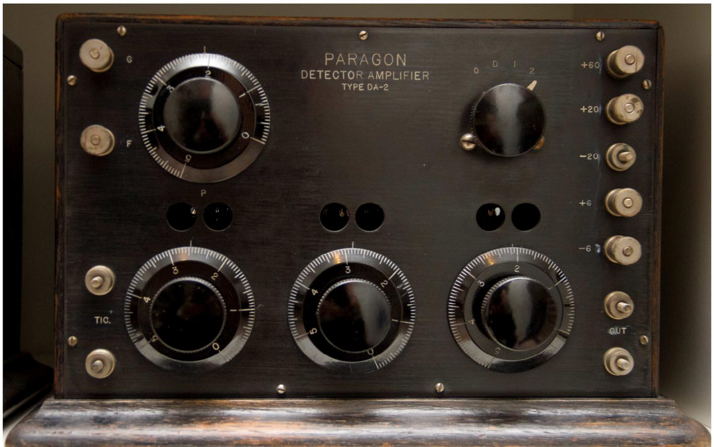
Amplificatore e detector DA2 per RA10.
