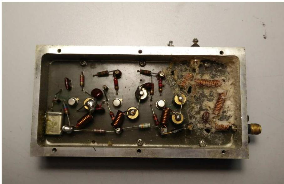
Figura 4 - Vista interna dell'oscillatore. TOP
